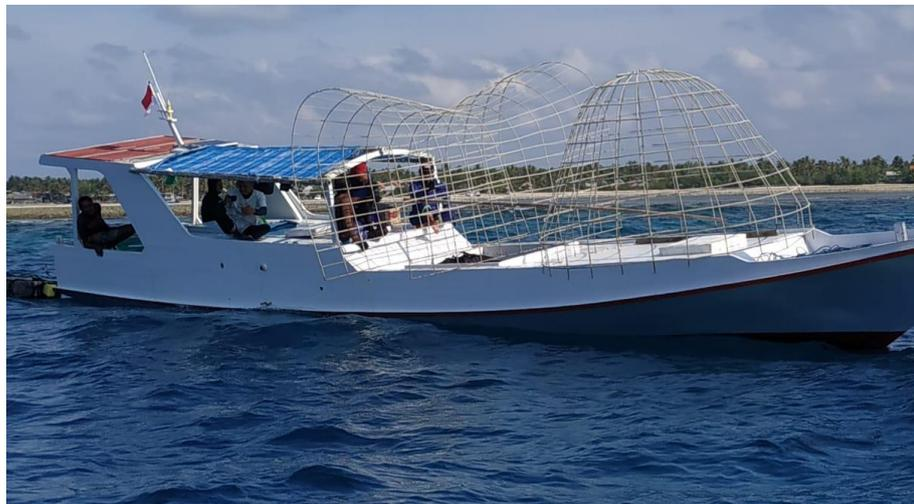
**Gambar 4.5** Pengangkutan rangka besi untuk terumbu buatan dan media transplantasi karang dari tempat pembuatan menuju lokasi transplantasi menggunakan perahu nelayan lokal (dokumentasi kegiatan, 2020)
